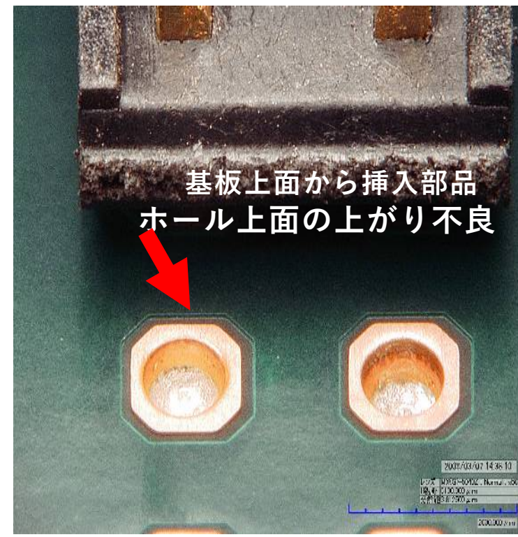
ボイドや濡れ不足の恐れあり
